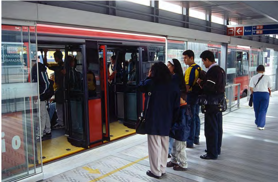
Figur 14 Påstigning i BRT-fordon där hållplatsens golv anpassats till bussens golvhöjd. Bild: Volvo
