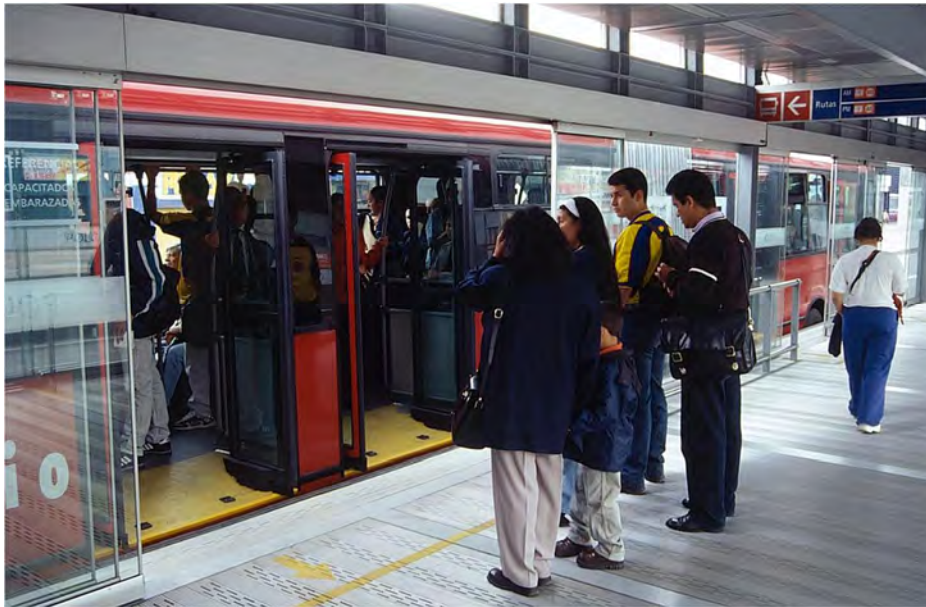
Figur 14 Påstigning i BRT-fordon där hållplatsens golv anpassats till bussens golvhöjd. Bild: Volvo
