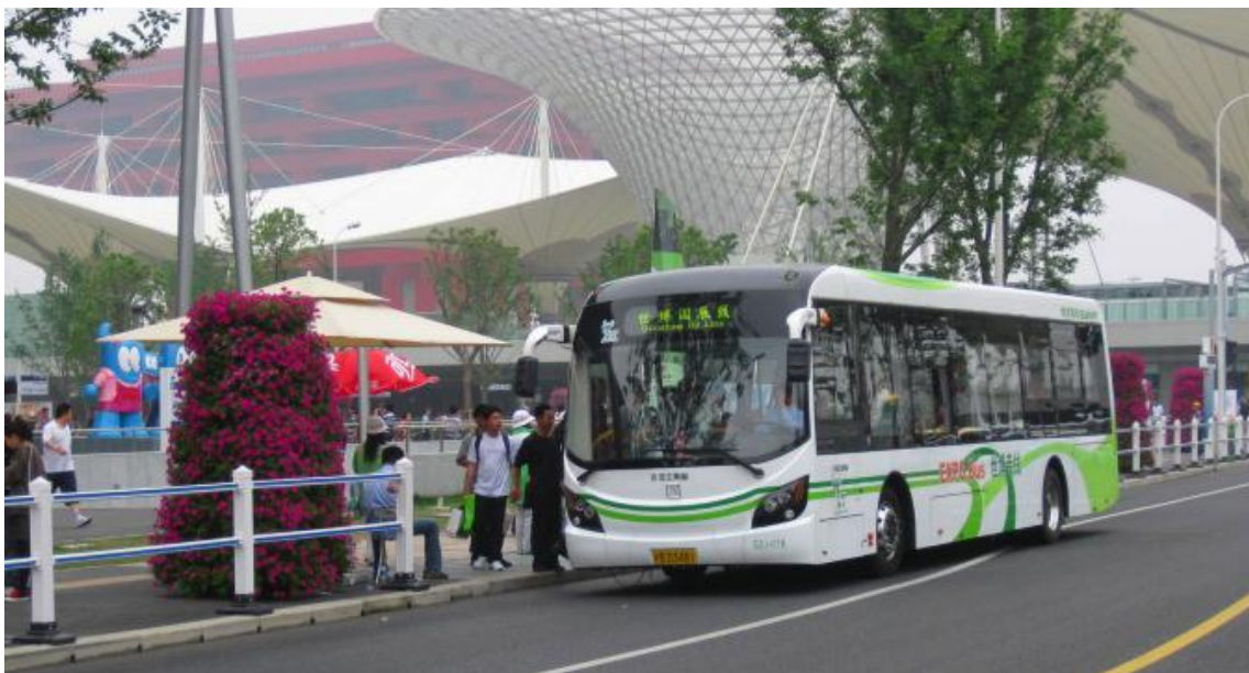
Figur 12. Dieselhybridbuss ger 30 % lägre bränsleförbrukning och mycket tysta hållplatsuppehåll då elmotorer driver hjälpapparater och en elmotor accelererar bussen varvid accelerationen blir tyst. Bild: Volvo
