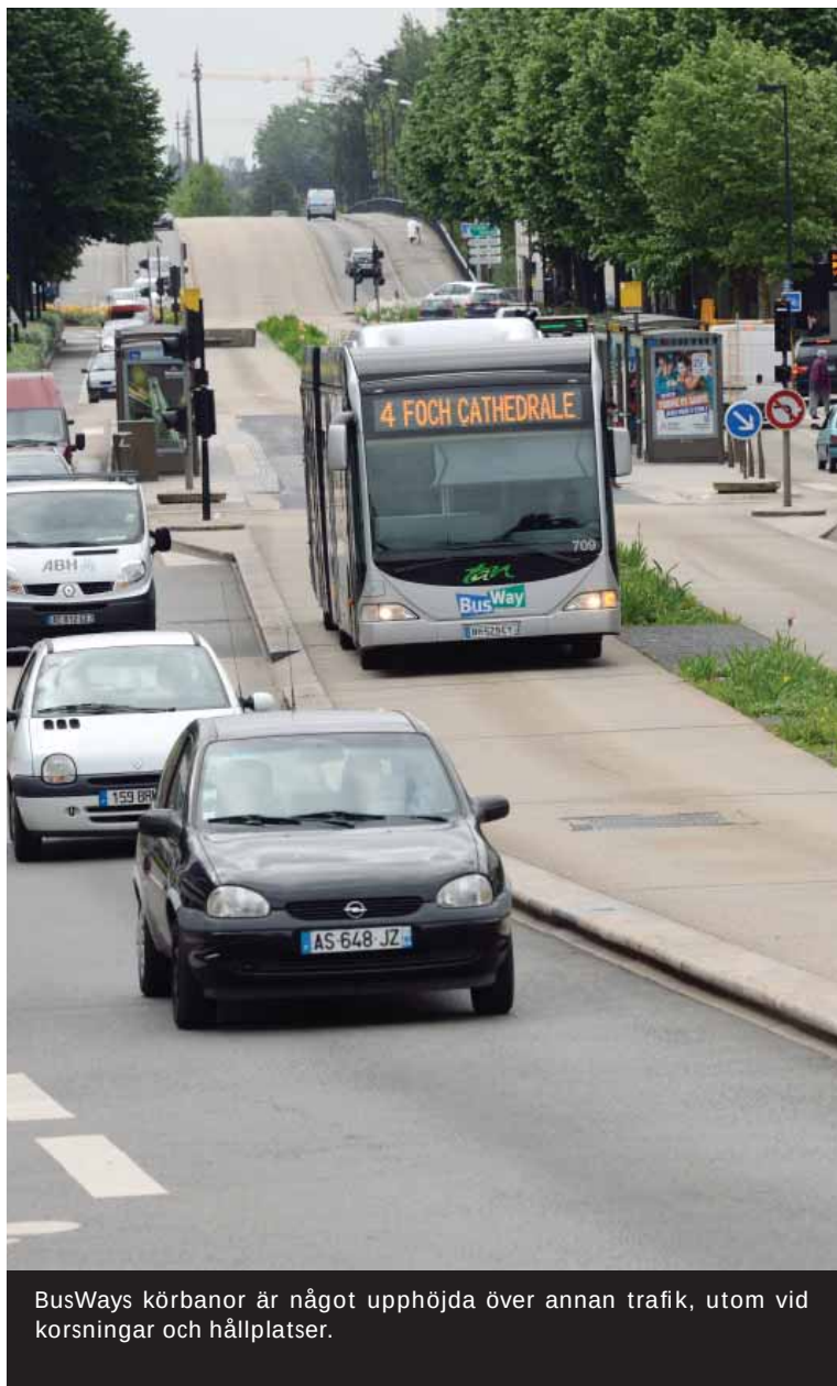
Hållplatsuppehållen på BusWay är extremt korta eftersom alla dörrar används till på- och avstigning. Det gör att man på en halv minut klarar åtminstone 25 påstigande och ett antal avstigande. Så snabbt går det ingenstans i Sverige!
